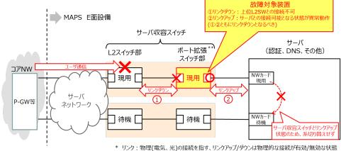
リンク:物理(電気、光)の接続を指す、リンクアップ/ダウンは物理的な接続が有効/無効な状態
