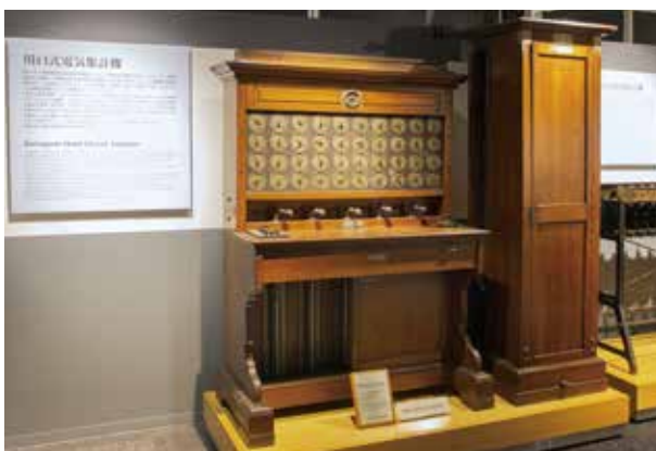
▲統計博物館に展示されている川口式電気集計機は、明治38年に作られた我が国初の統計集計機であり、情報処理技術遺産に認定されるなど、当時の情報処理技術レベルを知る上でも貴重な遺産とされています。
