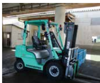
フォークリフトで魚を運搬する際、自動計量することで作業労力を軽減し、出荷の時間短縮を図る。
