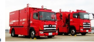
海水利用型消防水利システム
