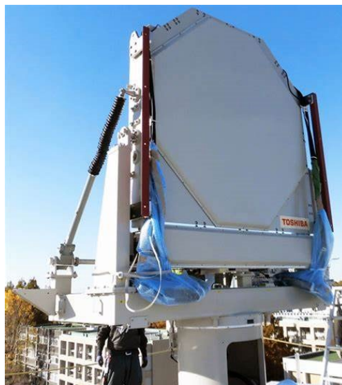
図 1. 2-5 二重偏波フェーズドアレイ気象レーダー（MP-PAWR）の外観
