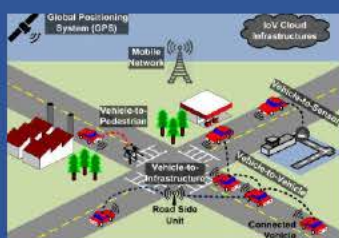
車両と車両間の通信による 安全運行管理 (台湾、アメリカ及び東南アジア)
