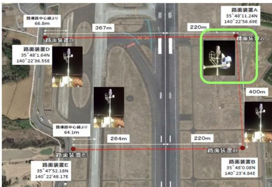
図4 成田国際空港における路面装置(レーダー装置)の配置
