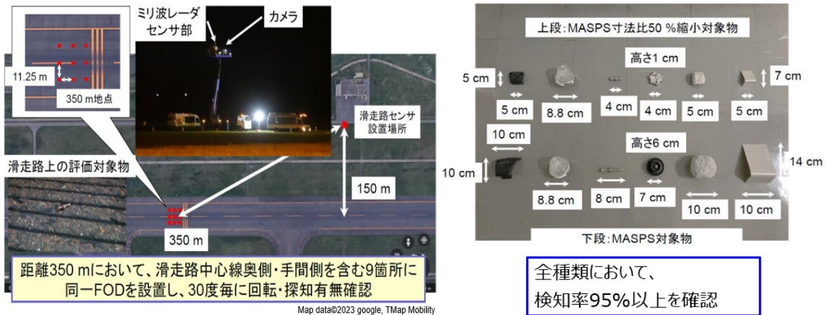
図 7 最低性能要件探知率試験の様子
